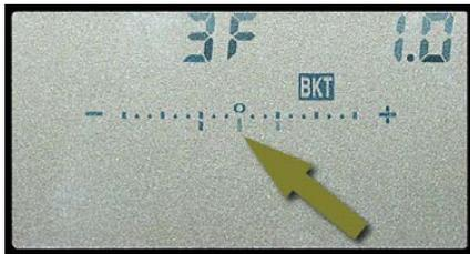
Wenn Sie nach dem Auslösen wissen wollen, wie viele Schritte bis zum Komplettieren der Belichtungsreihe noch nötig sind, reicht ein Blick auf das LC-Display. Die Aufnahmen, die bereits geschossen wurden, werden nämlich nicht
