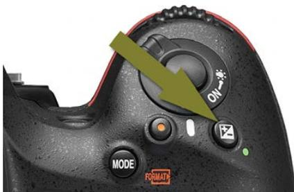
**2** Drehen Sie dann das hintere Einstellrad nach rechts, wenn das Bild überbelichtet werden soll. Dies wird mit positiven Werten symbolisiert.
