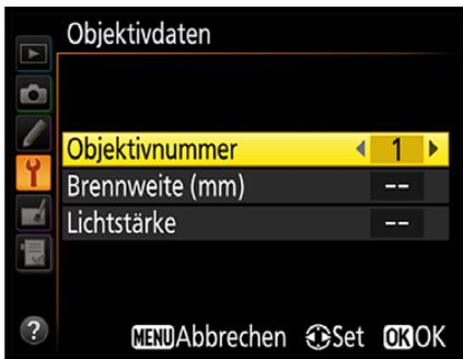
**3** Stellen Sie die Brennweite des verwendeten Objektivs ein. Es ist eine Angabe von 6 bis 4000 mm möglich.
