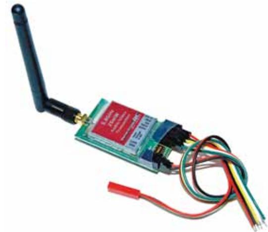
5,8-GHz-Sender mit 25 mW der Firma Immersions RC. (Bild: Globe-Flight)
