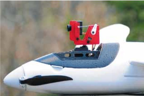
Kamera auf eine Schwenk-Neige-Vorrichtung montiert; dadurch kann sich der Pilot frei in der Umgebung umsehen. (Bild: Globe-Flight)
