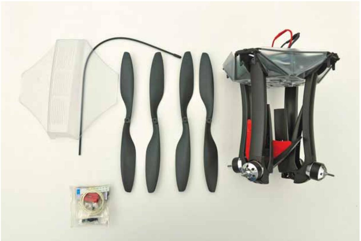
**Bild 3.1** – Der Quadrokooper kommt fast fertig zusammengebaut. An ihm sind im Wesentlichen nur noch die Propeller zu montieren.
