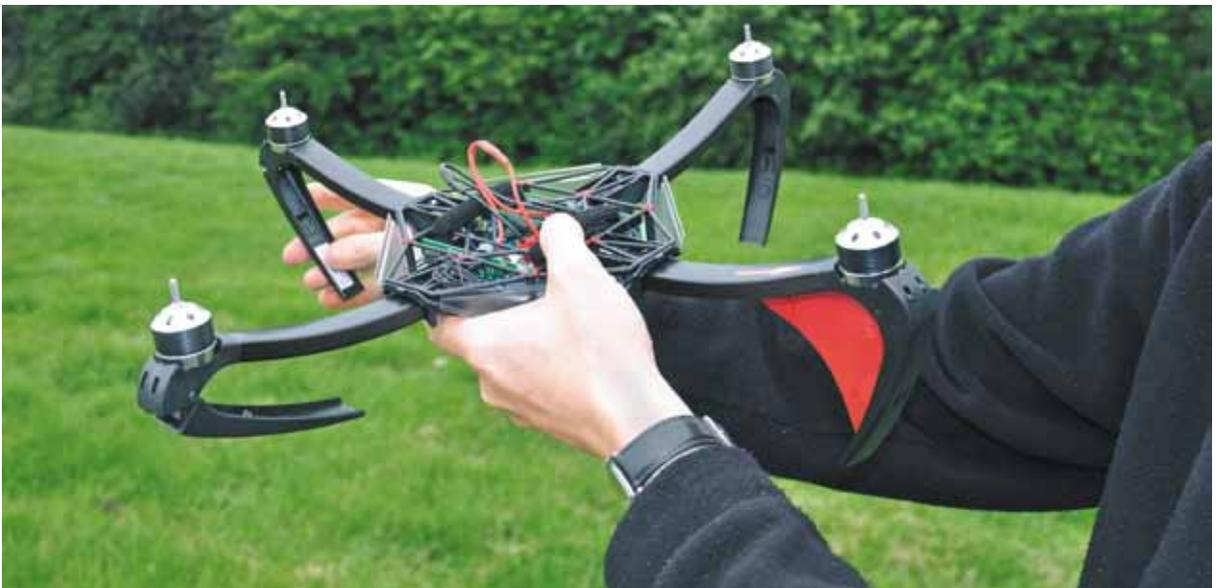
**Bild 3.5** – Zuletzt sind die LandefüÙe auszuklappen, bis sie einrasten.
