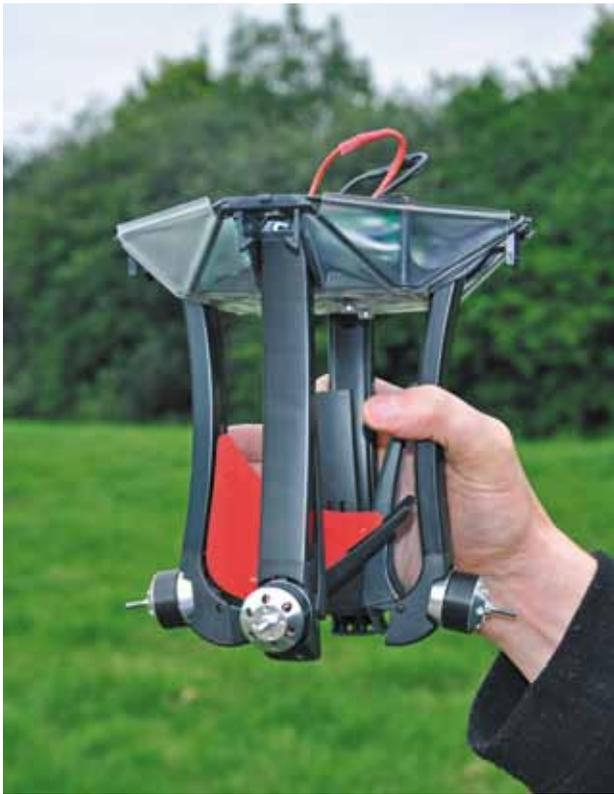
**Bild 3.2** – Der Quadrocopter ist zusammengelegt und beansprucht für den Transport nur wenig Platz.
