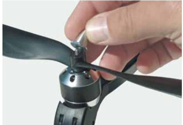
**Bild 3.10** – Nachdem das Rotorblatt auf die Motorwelle gesteckt wurde, ist eine Unterlegscheibe draufzulegen. Zuletzt wird der Rotor mit einer Rotorspitze fixiert.
