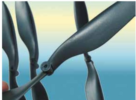
**Bild 3.8** – Die Rotorblätter sind mit „Left“ für links und „Right“ für rechts beschriftet.
