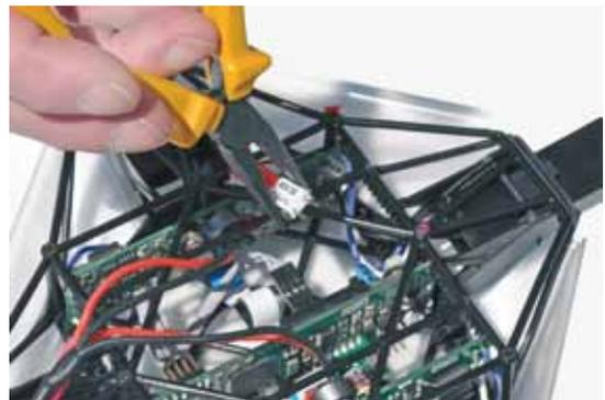
Bild 3.13 – Der Empfangsquarz ist am besten mit einer Zange einzubauen.
