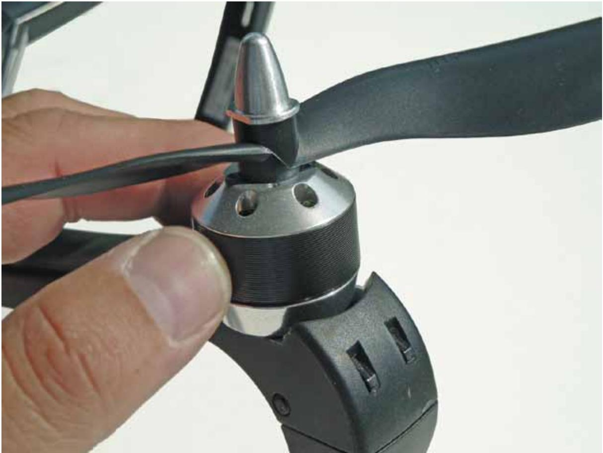
**Bild 2.1** – Beim BL-Außenläufer dreht sich das Gehäuse. So wird ein hohes Drehmoment erreicht, das auch große Propeller antreibt.
