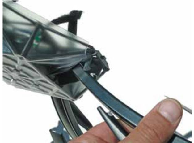
**Bild 3.4** – ... bis sie in den Arretierungen des Zentralrahmens einschnappen.
