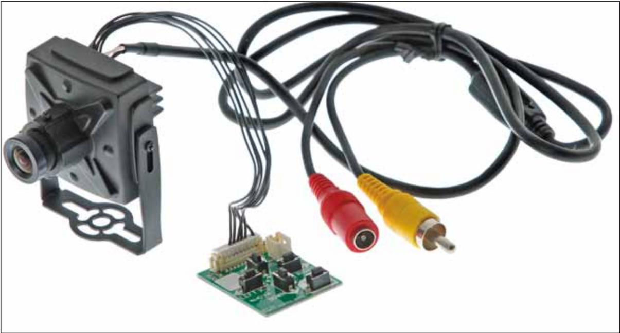
Gute FPV Kameras können über eine kleine „Tastatur“ sehr gut an die Lichtverhältnisse angepasst werden. Die Einstellmöglichkeiten werden am Bildschirm dargestellt. (Bild: Globe-Flight)
