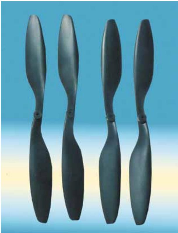
**Bild 3.7** – Da sich je zwei Motoren im und gegen den Uhrzeigersinn drehen, werden auch zwei Arten von Rotorblättern benötigt.
