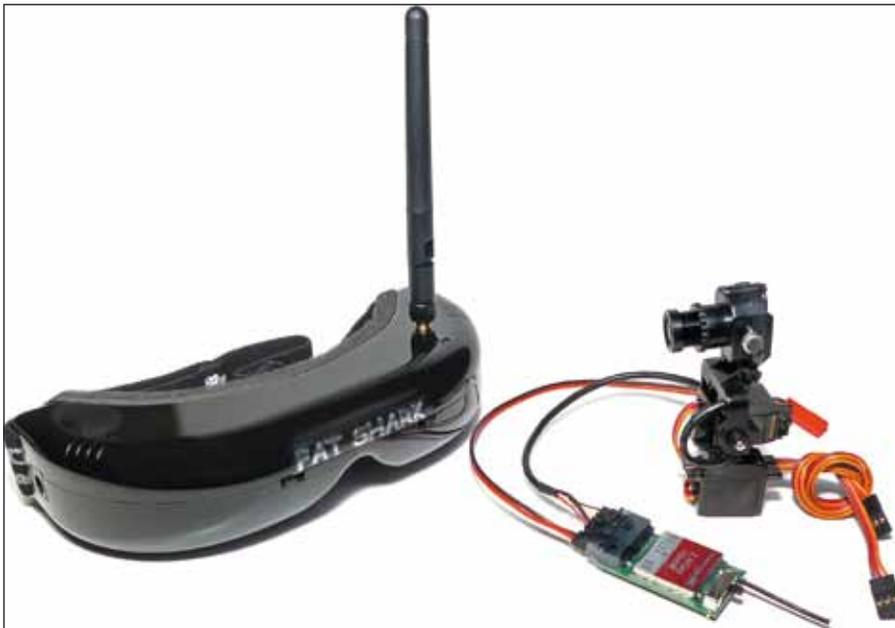
Videobrillen werden auch im Set angeboten. Sie enthalten meist Sender, Empfänger und eine Einsteigerkamera. Damit ist der schnelle Start ohne große Lötarbeiten gewährleistet. (Bild: Globe-Flight)
