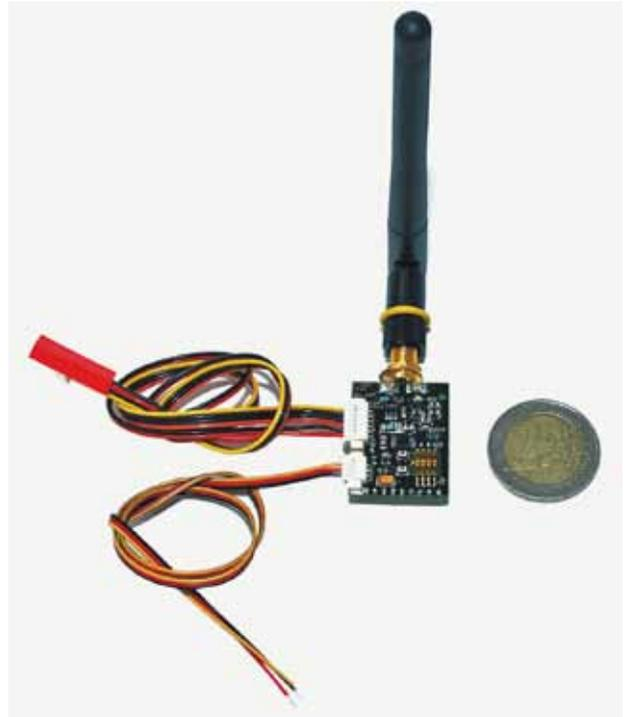
In einer höheren Preisklasse bekommt man auch sehr kleine Sender mit geringem Gewicht. Dazu gehört der 5,8-GHz-„Stinger PRO“. (Bild: Globe-Flight)
