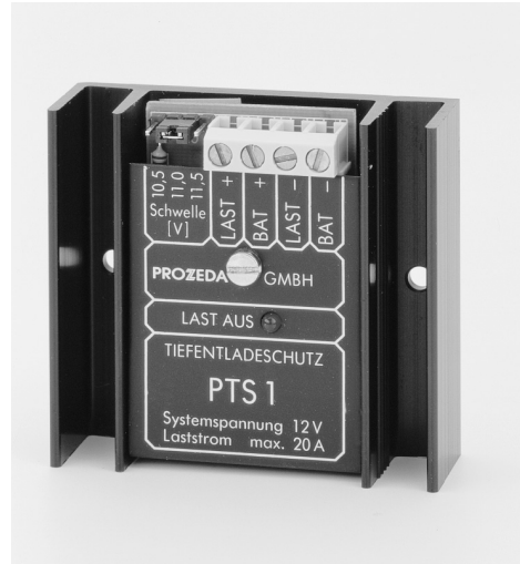
Abb. 1.7: Ausführungsbeispiel eines Tiefentladeschutz-Gerätes (Foto Conrad Electronic)
