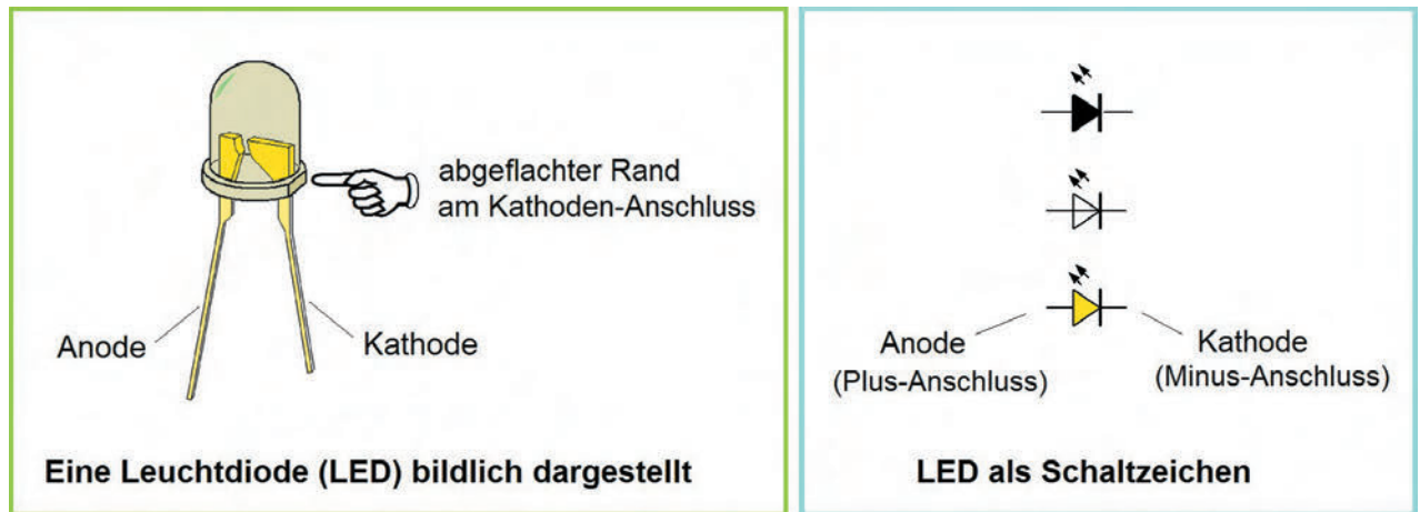
Abb. 1.1 – Leuchtdiode (Standard-Radialform) in natura und als Schaltzeichen
