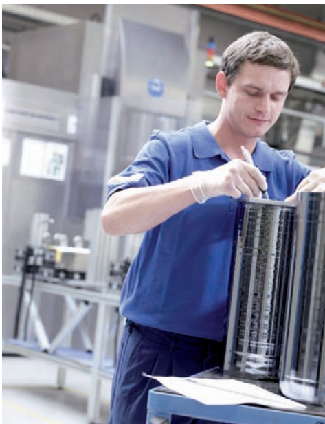
Abb. 1.13: Block aus monokristallinem Silizium vor dem Zersägen in einzelne Wafer. (Foto: Ersol)
