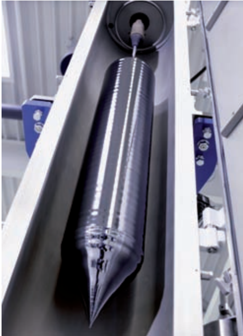
Abb. 1.12: Monokristallines Silizium als Einkristallstab. (Foto: Ersol)
