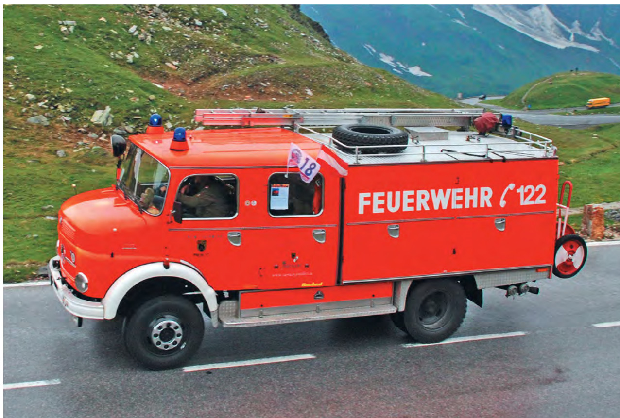
Abb. 2.3 – Tanklöschfahrzeug auf dem Fahrgestell des Mercedes Benz 1113-B von 1970.
