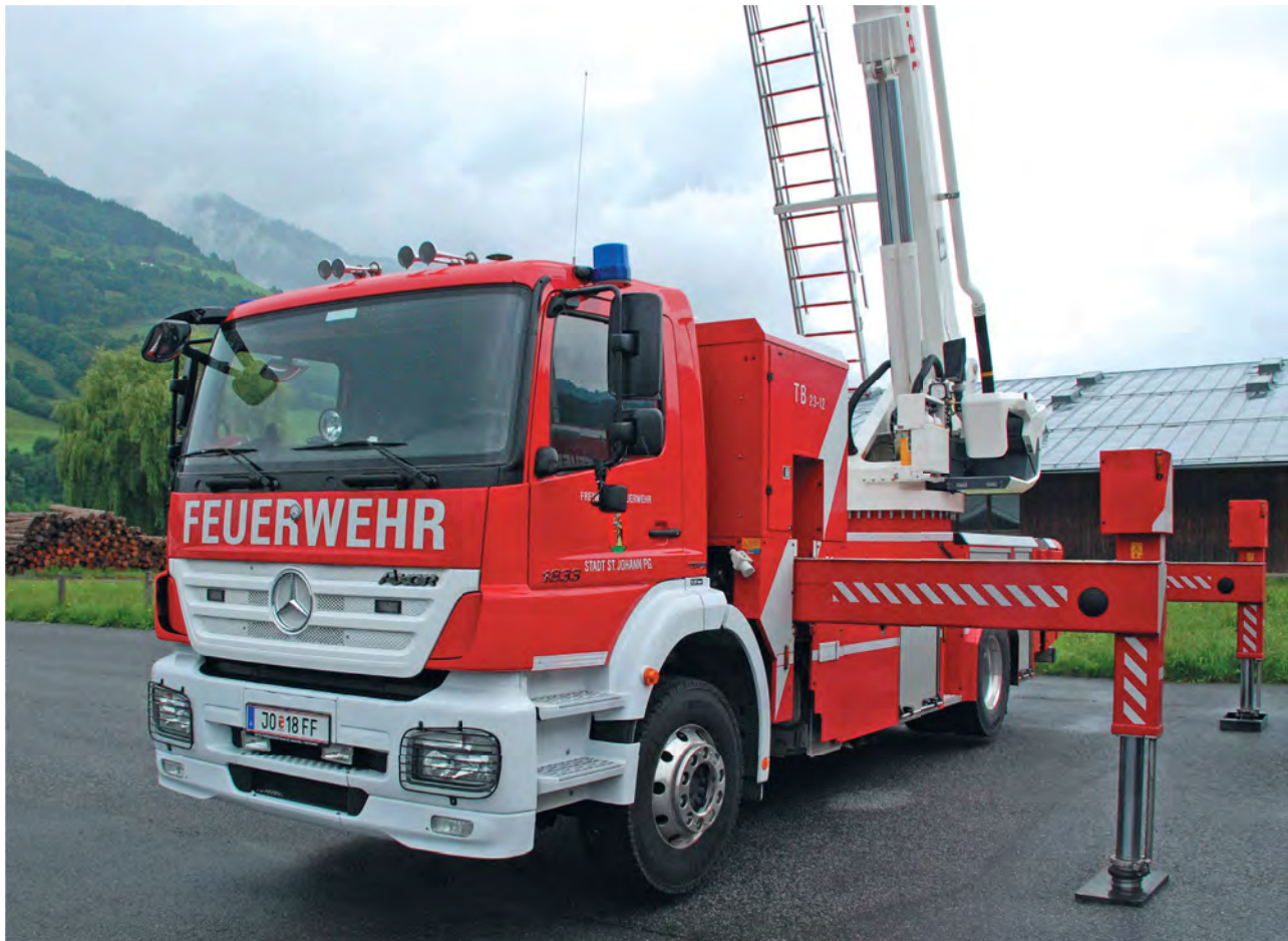
Abb. 2.7 – Hubarbeitsbühne mit an den Seiten ausgefahrenen Stützen.
