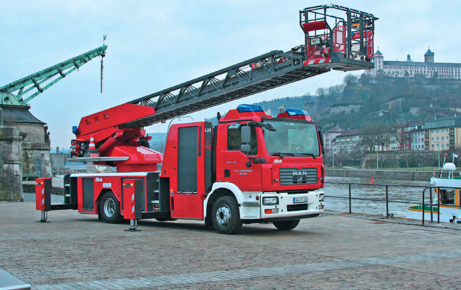
Abb. 2.6 – Drehleiter mit Korb der staatlichen Feuerweherschule Würzburg. (Foto: Rosenbauer)
