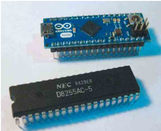
Abb. 1.3: Arduino Micro im Vergleich mit einem klassischen IC
