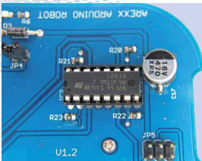
L293D-Chip mit integrierter H-Brücke
