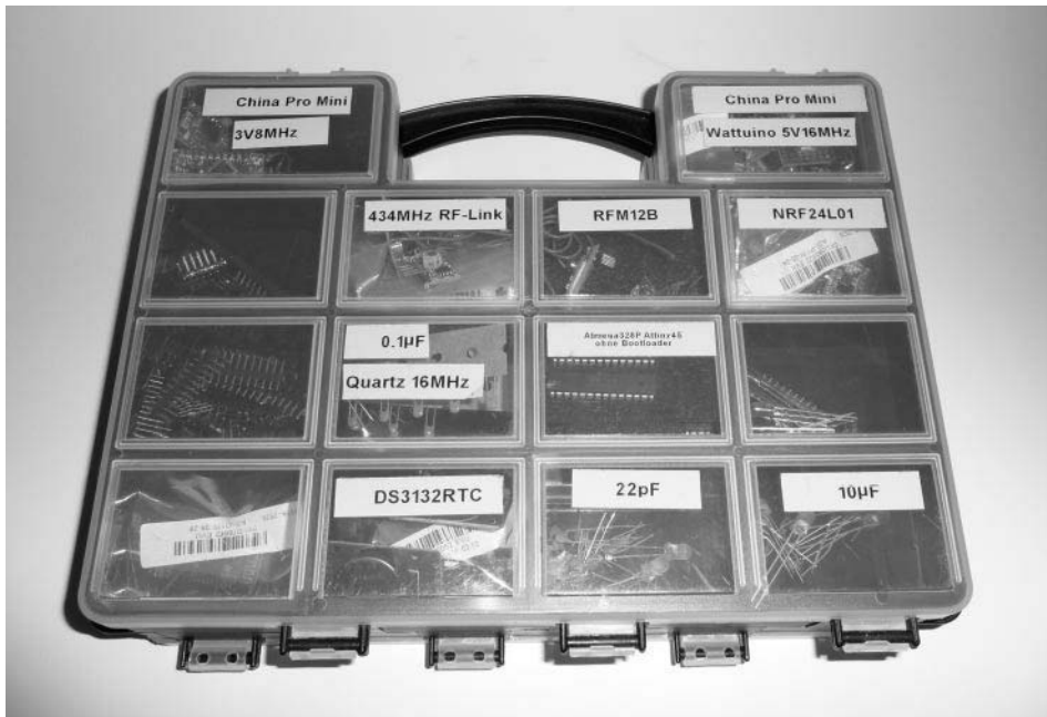
Bild 1.5: In Kleinteilekoffern bringen Sie eine Menge elektronischer Komponenten unter – Fächer für Mikrocontroller sollten Sie mit antistatischem Schaumstoff auspolstern.
