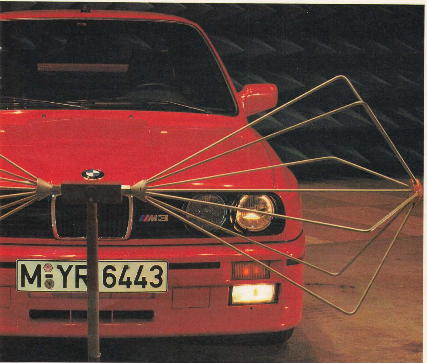
Bild 1: Der BMW-M3 in der EMV-Absorberhalle von MBB in Ottobrunn bei München. Eine biconische Antenne dient zum Anstrahlen des Testobjekts zwischen 20...200 MHz, dem für Kraftfahrzeuge extrem kritischen Frequenzbereich. Schließlich handelt es sich um Wellenlängen zwischen 15...1,5 m. Und Autos sind bekanntlicherweise auch so lang.
