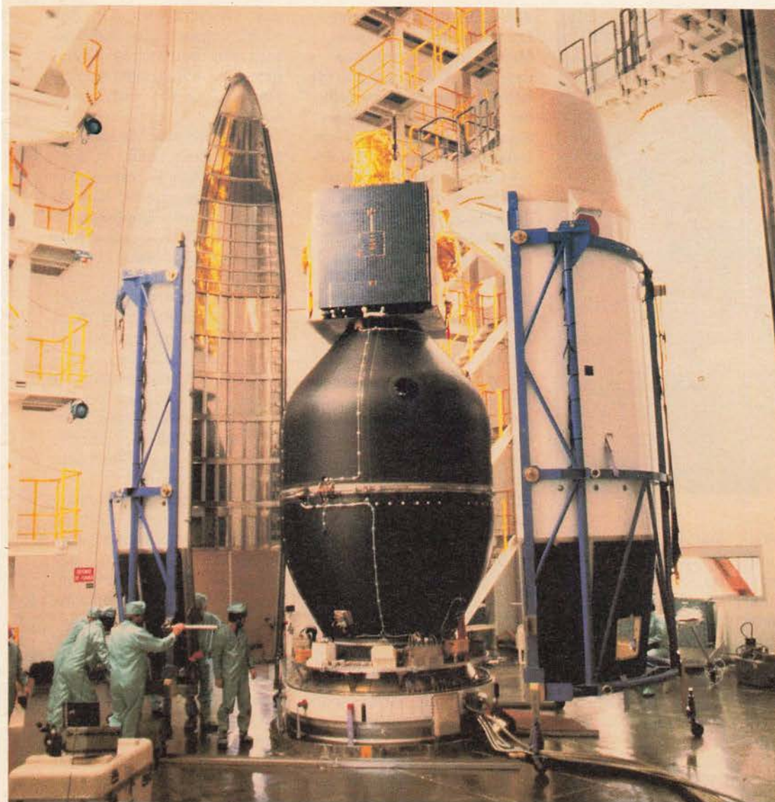
Bild 3: Im 16. Stock des Montageturmes, wo die Satelliten eines Doppelschusses – im Bild: G-Star und Brasilia 2 für Flug V.17 – auf der Spitze der fast 49 m hohen Ariane 3 montiert werden.
