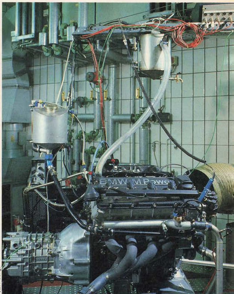
Blick in einen BMW-Prüfstand: Über zahlreiche Meßfühler werden während des Testlaufs wichtige Betriebsdaten ermittelt.
