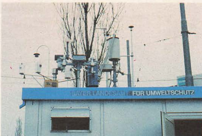
Durch ein Netz von 90 solcher Meßstationen wird in Bayern und Hessen die Luftgüte laufend überwacht.
