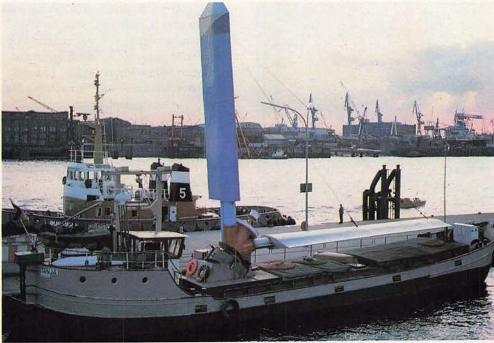
Der Wagner-Rotor, ein skurril anmutendes, aber dennoch erfolgversprechendes Konzept der Windenergie-Nutzung.
