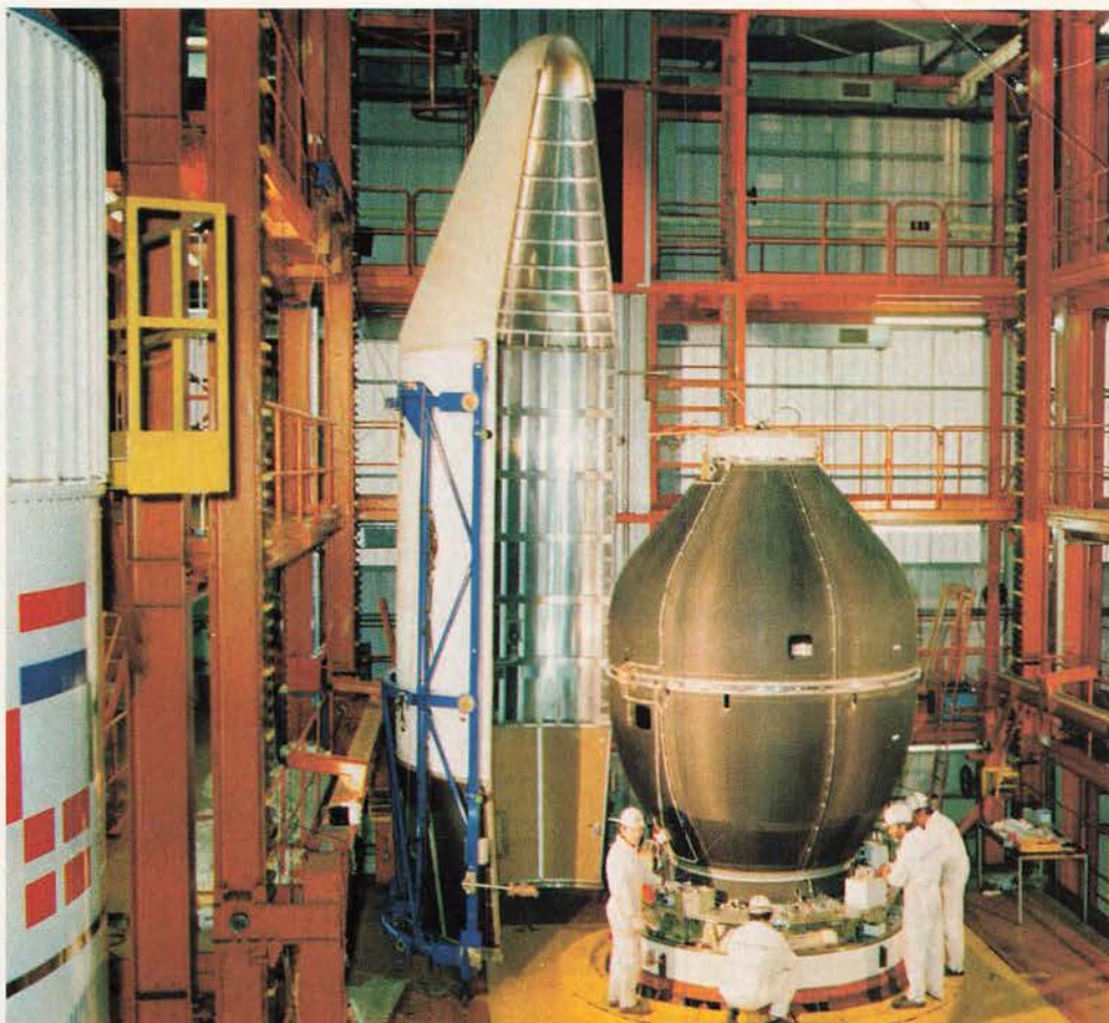
Dieser SYLDA genannte Kunststoffkokon ermöglicht den gleichzeitigen Start von zwei Satelliten auf verschiedene Umlaufbahnen.
