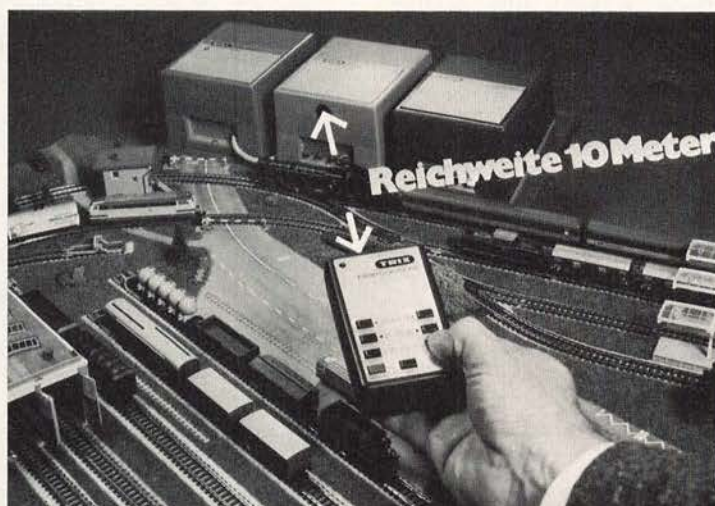
Bild 8: Telecontrol – ein Infrarotfernsteuersystem von Trix für drei Züge.
