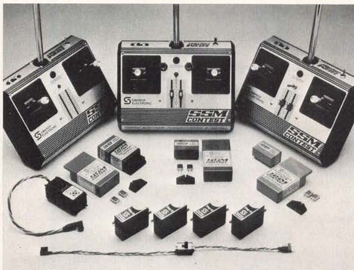
Bild 1: Das SSM-Contest Programm von Simprop Electronic. Als Besonderheit arbeitet diese Anlage mit Sinus-Schmalbandmodulation.
