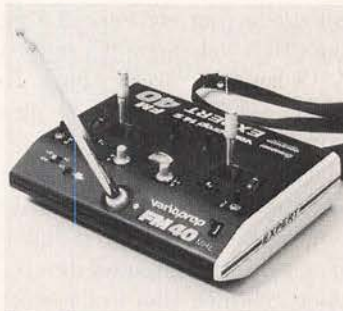
Bild 3: Vario-prop-Expert Sender für Proportional- und Exponentialsteuerung.
