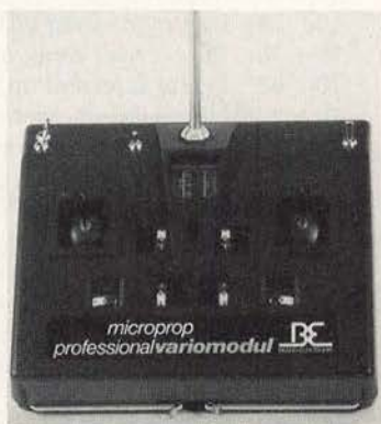
Bild 7: Doppelinstrument, 270° Trimmweg und Ruderwegumschalter kennzeichnen den Variomodulsender. Die „open Sticks“ sind mit einer Staubschutzkappe versehen.
