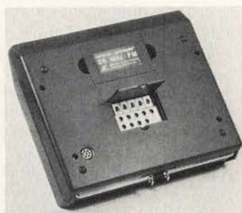
Bild 6: Variomodulsender mit geöffneter Programmierereinheit, darüber das eingesetzte HF-Modul.
