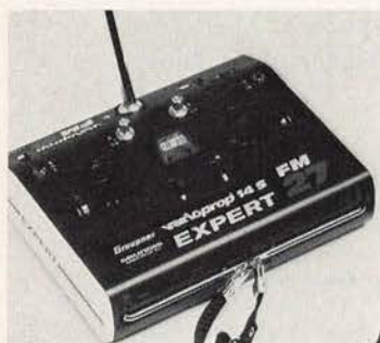
Bild 4: Varioprop-Expert Sender mit digitalem Kurzzeitmesser.
