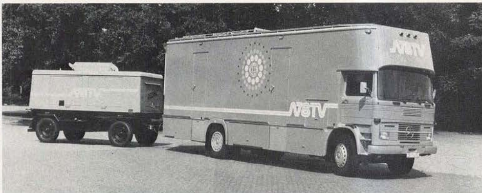
Der Farbfernsehubertragungswagen enthält alle technischen Einrichtungen für eine Übertragung. Im Anhänger befindet sich lediglich noch der Strom-Generator (Werkaufnahme: Bosch).
