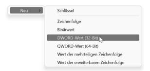
2. Der Registrierungs-Editor erstellt daraufhin einen neuen Wert mit einem provisorischen Namen (üblicherweise Neuer Wert #1) und fügt diesen unten am Ende der Liste an. Ersetzen Sie diese Bezeichnung durch den erforderlichen Namen des Wertes. Übernehmen Sie die Bezeichnung mit -.
