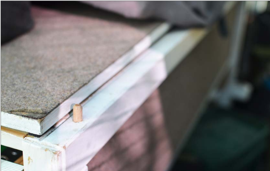
Fixiert wird die Bettplatte über im Bett eingelassene Holzdübel
