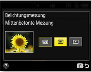
Messschwerpunkt auf einen größeren zentralen Bereich in der Bildmitte gelegt. Ich habe den Bereich im folgenden Bild hervorgehoben. Der zentrale Bereich ist 8 mm groß. Dieser Bereich erhält bei der Ermittlung der korrekten Belichtung eine Gewichtung von 75 %. Die mittenbetonte Belichtungsmessung ist gut geeignet, wenn ein helles oder dunkles Objekt das Bild dominiert und die Matrixmessung nicht zu einem optimalen Ergebnis führt.
