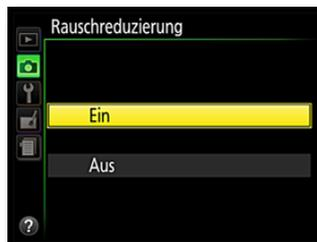
Die Rauschreduzierung greift auch dann ein, wenn Sie mit einer höheren Empfindlichkeit arbeiten. Ist die Option deaktiviert, wird die Rauschreduzierung bei höheren Empfindlichkeiten
