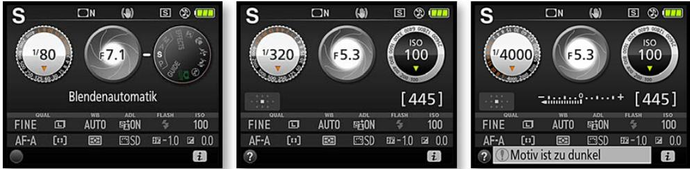
Blendenautomatik aber im Normalfall kaum erleben. Haben Sie die Blendenautomatik mit dem Moduswahlrad ausgewählt, wird die gewünschte Belichtungszeit mit dem Einstellrad eingestellt.
