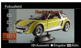
**1** Um die Größe des Autofokussmessfeldes zu verändern, drehen oder drücken Sie das Einstellrad. Sie sehen die drei Größen der Messfelder auf der nächsten Seite. Sie können eine der drei Größen auch im Menü auswählen. So sehen Sie im Bild links die Variante, bei der die kleinste Größe eingestellt wird.
