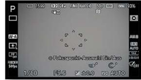
**2** Schieben Sie das Messfeld mit dem Einstellrad an die gewünschte Position. Im nachfolgenden linken Bild habe ich das Messfeld übrigens zur Demonstration an die äußerste mögliche linke untere Stelle geschoben. Sie sehen, dass der Bereich deutlich größer ist als bei der *Breit*-Option.
