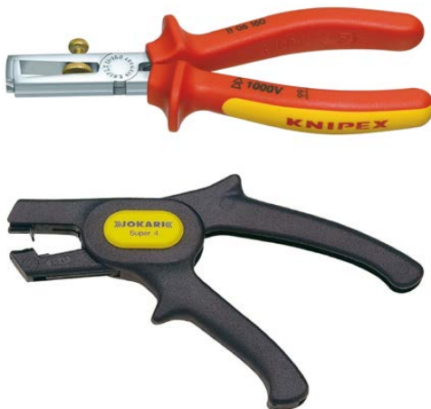
Abb. 7.13: Abisolierzangen gibt es in sehr vielen Ausführungen. Neben den einfachsten zwickzangenähnlichen Ausführungen gibt es auch »automatische« Werkzeuge
