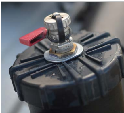
Zwei Löcher im Deckel sorgen für einen Druckausgleich bei geöffnetem Ventil
