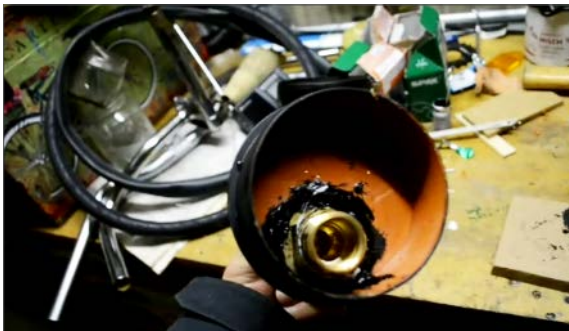
Das Gewinde für die Aufnahme der beiden Hähne/Ventile habe ich zusätzlich in die Deckel geklebt
